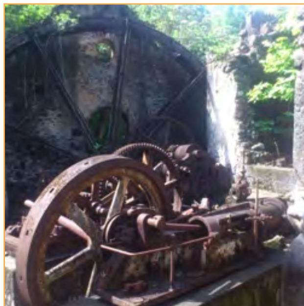
Habitation Anse Latouche au Carbet : la roue hydraulique était alimentée par un aqueduc (XVIII e siècle), lui-même alimenté grâce à une digue construite sur la rivière Latouche.
